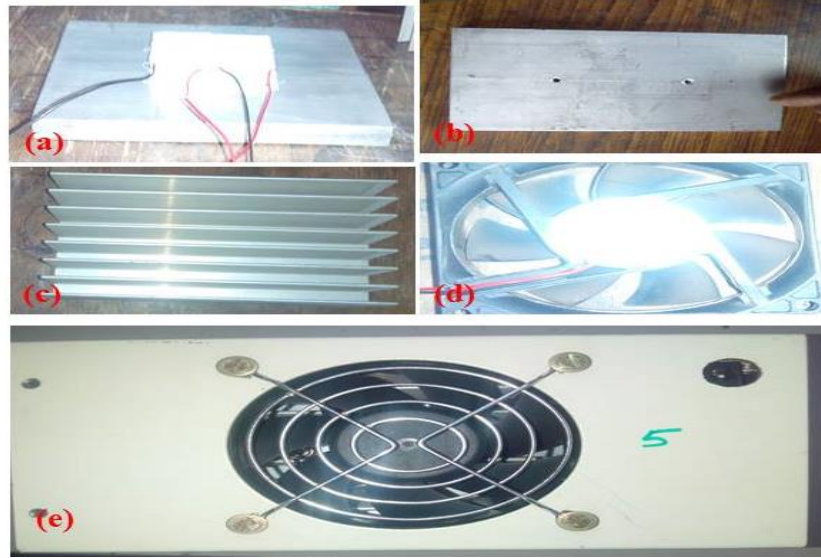
Figure 3.19: TEG module (b) Aluminium absorber (c) Heat sink (d) DC fan (e) Complete assembly of TEG
